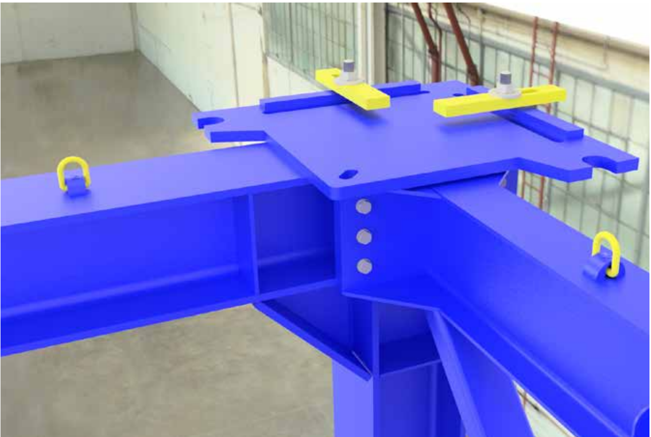
FIG. 2 - Dettaglio del golfare - Eyebolts detail
